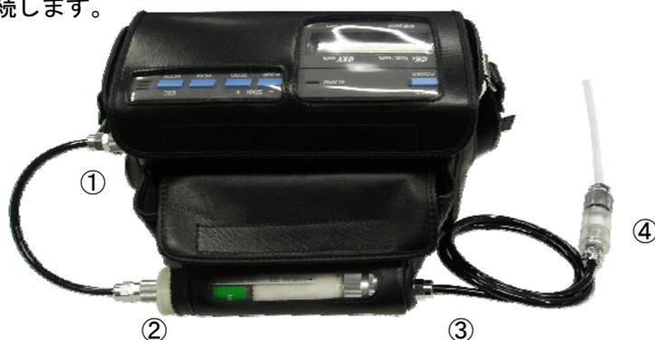
ガス採集方法には3種類の先端形状があり、それぞれ測定環境に合わせて使い分けて下さい。
